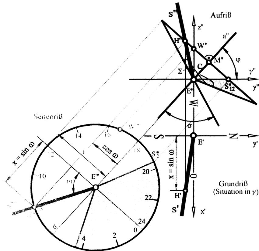
Abb. 4: Konstruktion des Lichtstrahls zu geg. Datum und geg. Uhrzeit
