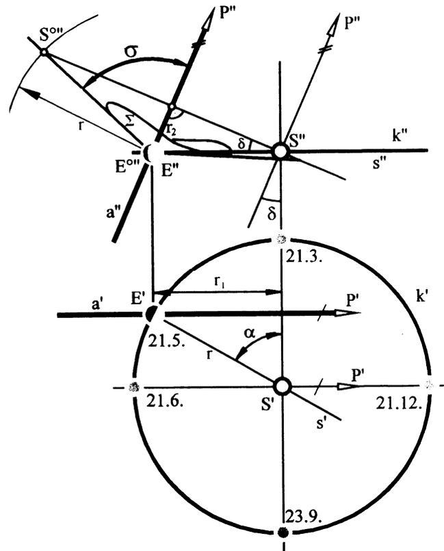
Abb. 2: Die Ermittlung des charakteristischen Winkels  $\sigma$
