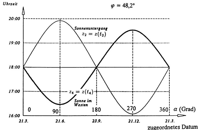
Abb. 6: Sonnenuntergang und exakte „West-Position“ für  $\varphi = 48.2^\circ$
