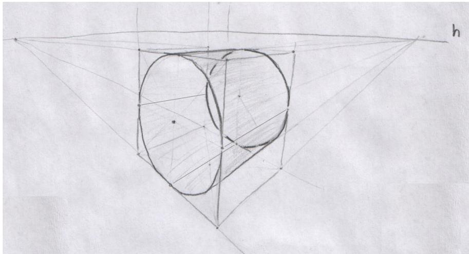
Abbildung 6: Liegender Kreiszyylinder (Rohr) in Perspektive
