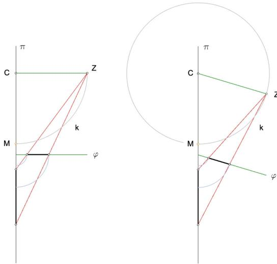
Abbildung 10: Messpunktverfahren
