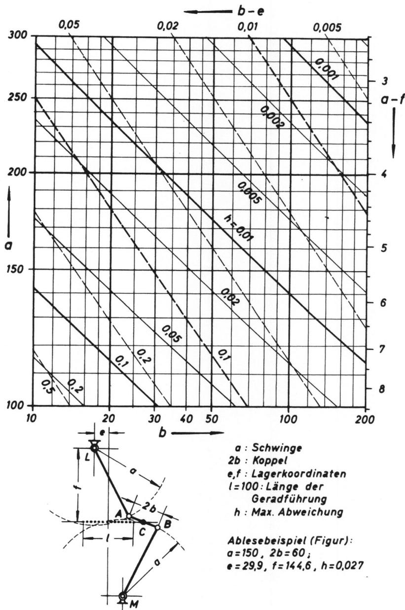
Bild 1. Netztafel für fein optimierte Geradföhrungen.
